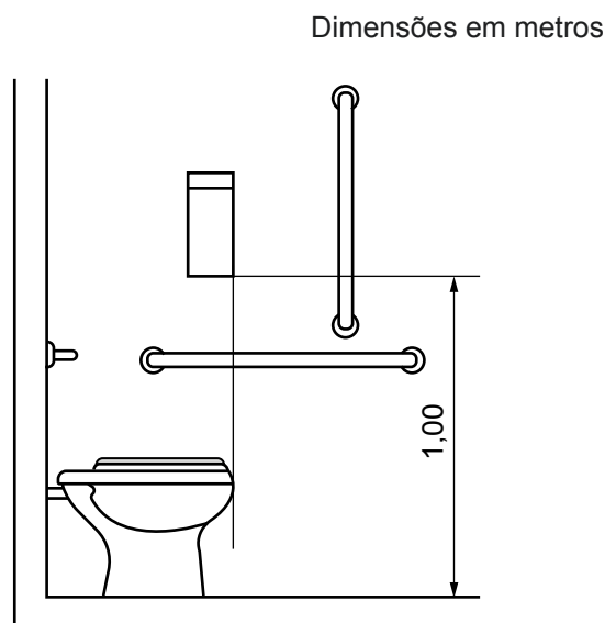
Figura 125 – Localização da papeladeira de sobrepor (interfolhado) – Vista lateral
